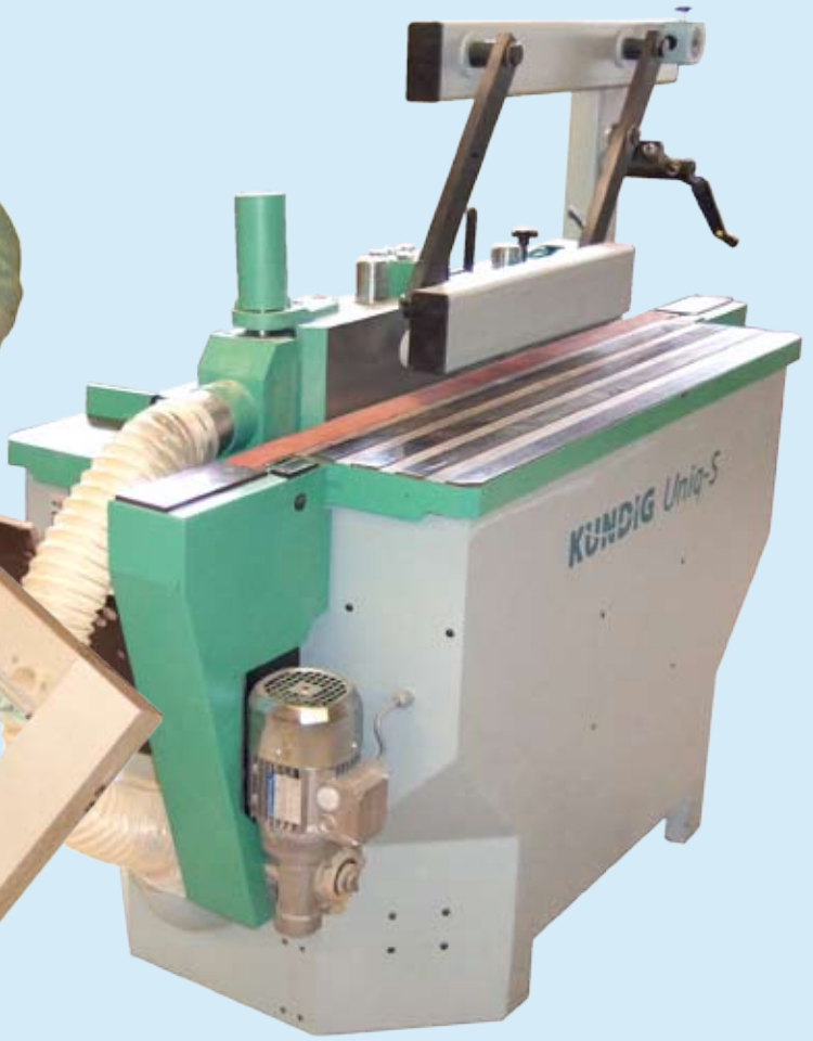
Michel Mooser vor seiner neuen Kanten-Schleifmaschine KÜNDIG Uniq-S
