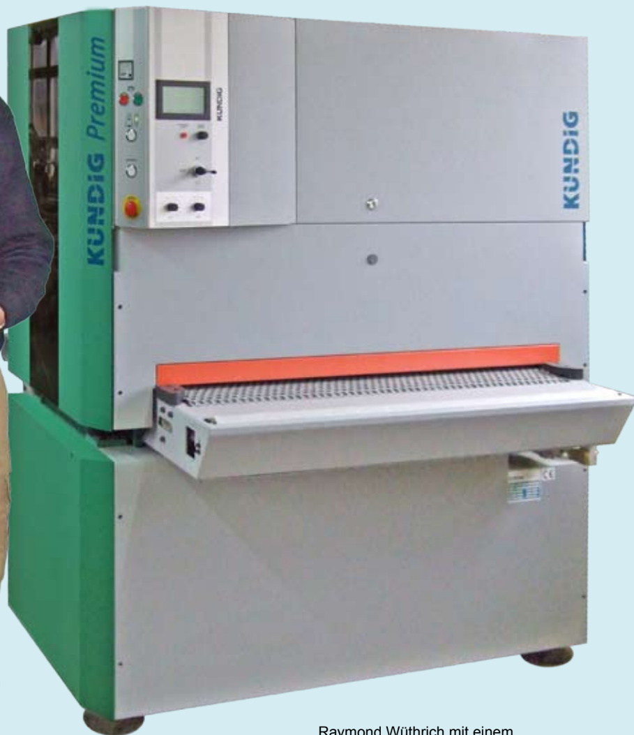
Raymond Wüthrich mit einem Einlageteil für die speziellen Arbeitstische der Uhrenindustrie vor der neuen KÜNDIG Premium-1 Breitband-Schleifmaschine
