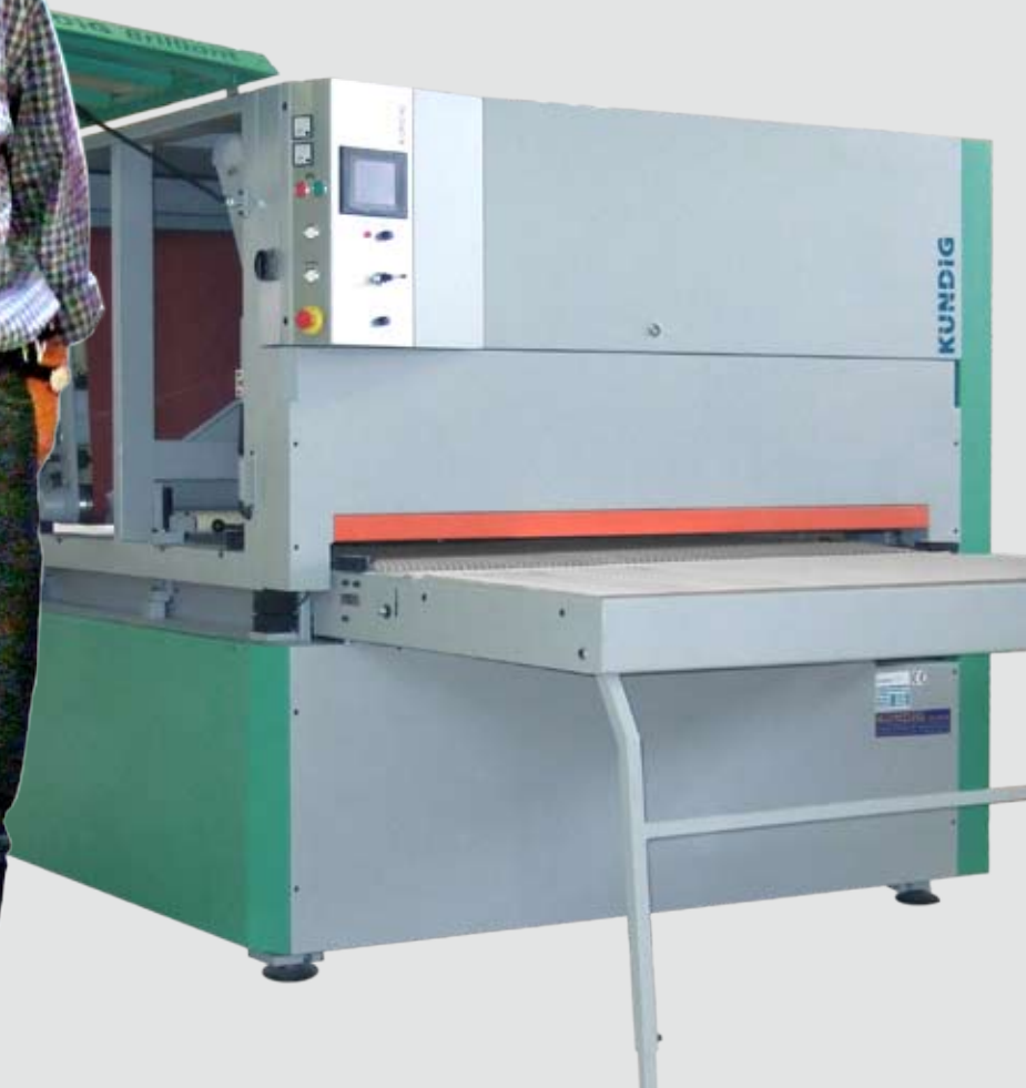
Matthias Klein vor der KÜNDIG Brilliant-2 V-Max Breitband-Schleifmaschine
